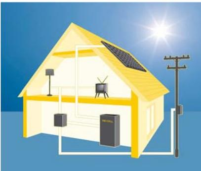
Das System: Sonne am Himmel, PV-Module auf dem Dach, Batterie und Wechselrichter im Keller, Netzanschluss neben dem Haus.
